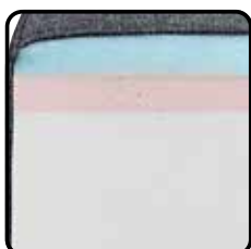
Variant 3: stevig zitkussen (optie) Nosagveren*, onderlaag HR-schuim 35kg/m 3 , bovenlaag viscoschuim 45 kg/m 3 , dacron afdeklaag
